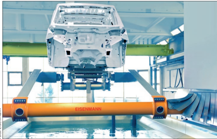
Tauchsystem VarioShuttleXL: Damit können auch schwere Karosserien bewegt werden.
